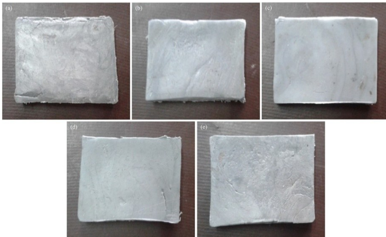
Fig. 1. Images of (a) 95-5 wt%, (b) 90-10 wt%, (c) 80-20 wt%, (d) 70-30 wt%, and (e) 60-40 wt% HDPE-aluminium
